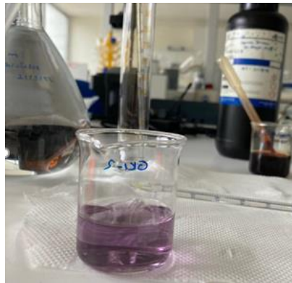
Fotoğraf 2.3 Asetaldehit analizinde titrasyon sonucu oluşan mor renk
