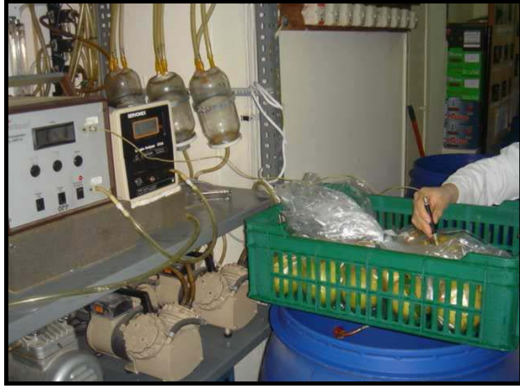
Şekil 3.19. MA’de depolama ortamında O 2 ve CO 2 konsantrasyonlarının belirlenmesi
