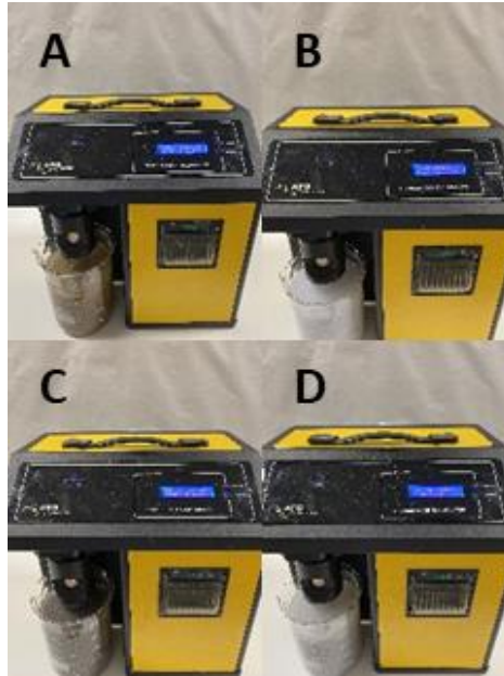
Şekil 2.8 : (A) Oluklu (B) Ofis (C) Gazete (D) Kuşe atık kağıtlarından oluşturulan hamurlara ait zeta potansiyel ölçümü.
