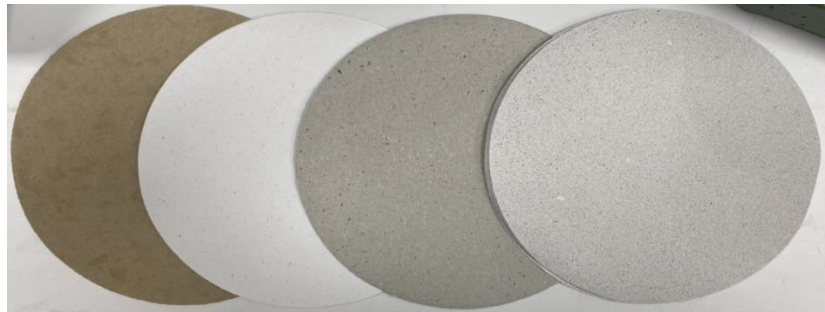
Şekil 2.9 : Laboratuvar koşullarında yapılan el kağıtları (Soldan sağa sırasıyla; oluklu, ofis, gazete ve kuşe atık kağıtları).
