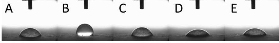
Şekil 3.24 : Oluklu (A) Kontrol (B) %1,5 AKD (C) %1,5 Nişasta (D) %1,5 %8'lik PAM (E) %1,5 %20'lik PAM.
