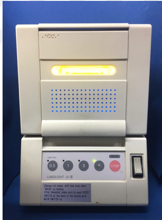
Şekil 3-8: İndirek kompozitin polimerize edilmesi
