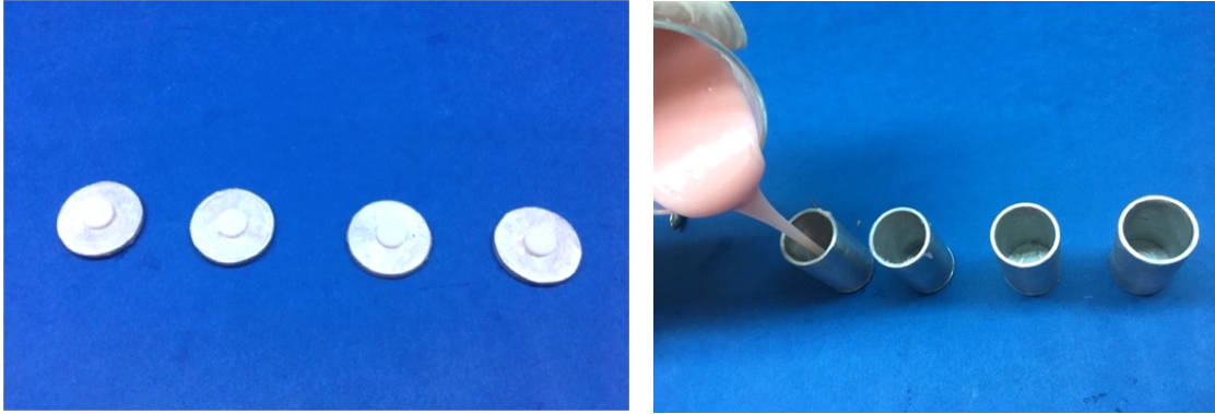
Şekil 3-11: Örneklerin akriliğe gömülmesi işlemi
