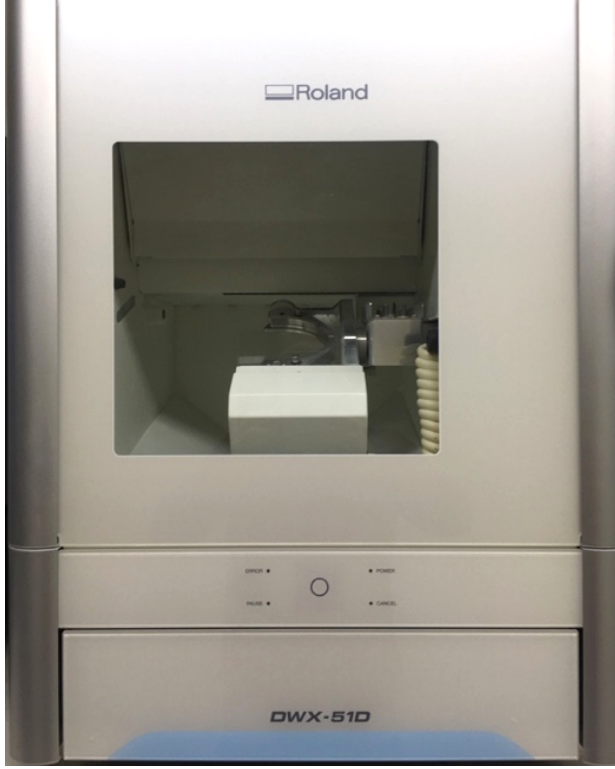
Şekil3-1: Roland DWX-51D cihazında zirkonya örneklerin kazınması
