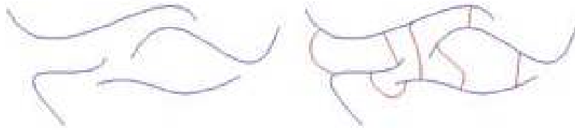
Şekil 2.24 Çapraz bağlı olan ve çapraz bağlı olmayan elastomerler arasındaki fark
