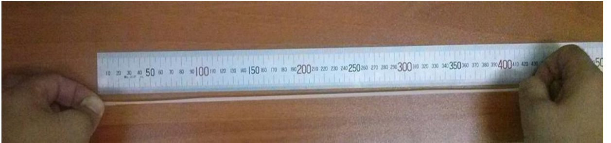
Şekil 4.6 Fotovulkanizasyon işlemi sonrası filmin uzaması
