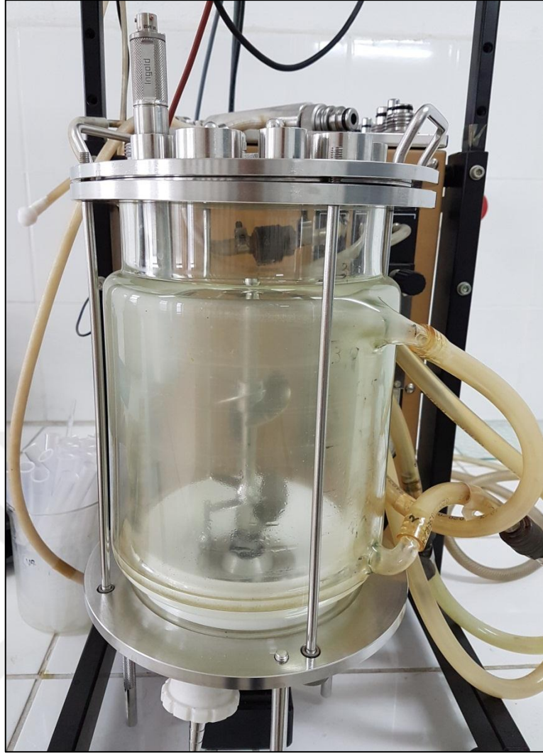
Şekil 13: Karıştırılmalı tank biyoreaktörü (Foto: Nejla Aşık, 2016).
