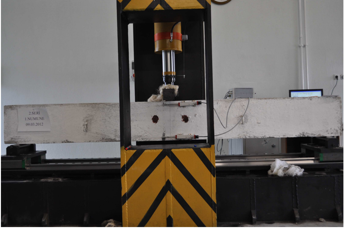
Resim 4.4 Rijit yükleme çerçevesinde 2. seri test numunesi
