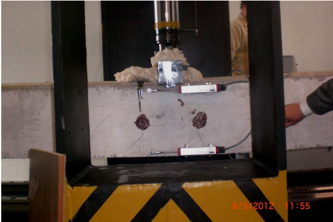
Resim 4.5 Betonarme kirişlerde yükleme durumu oluşan çatlakların görüntüsü
