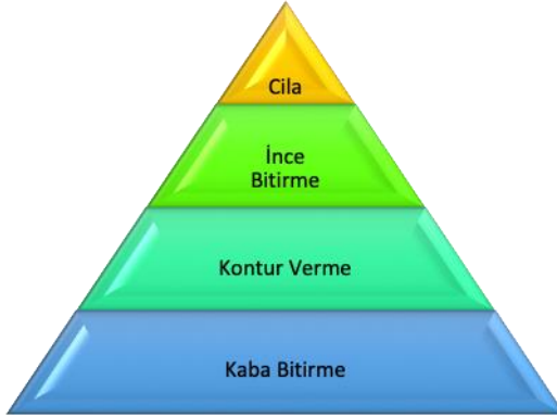
Şekil 2-4: Dental restoratif materyallerin bitirme ve cila işlem basamakları (Jefferies 2007)
