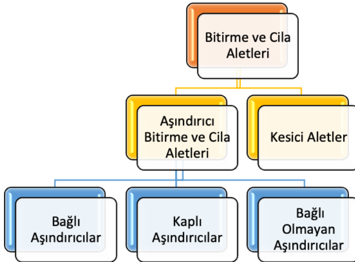
Şekil 2-5: Bitirme ve cila aletlerinin sınıflandırılması (Jefferies 1998; Anusavice ve ark. 2012)
