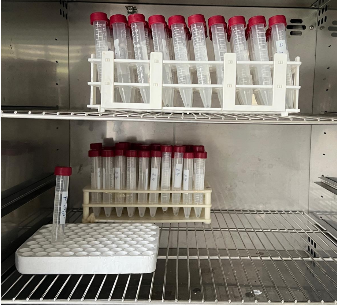
Fotoğraf 3.7 Bekletme süresi boyunca numunelerin 37°C’de inkübasyona tabi tutulduğu inkübatör iç yerleşimi.
