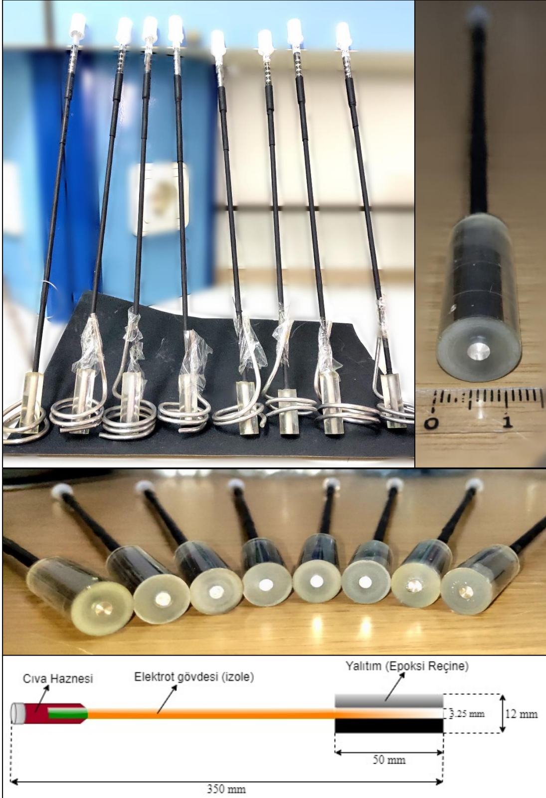
Şekil 4.1 : DDE şeklinde tasarlanmış farklı metal bileşimlerine sahip elektrotlara ait görseller ve ölçüleri de gösteren şematik çizimi.
