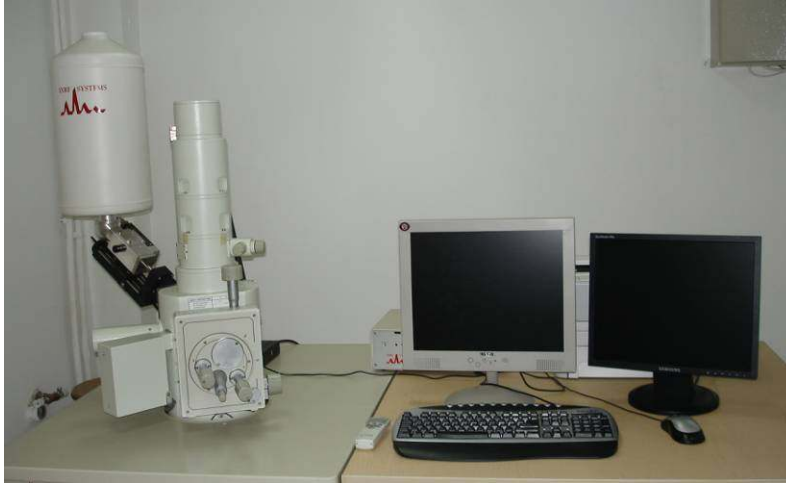
Resim 4.6. JOEL JSM-5600 model taramalı elektron mikroskobu ve EDS bağlantısı
