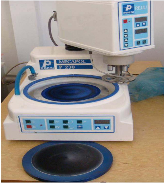
Resim 4.5. Mecapol P-230 marka parlatma cihazı
