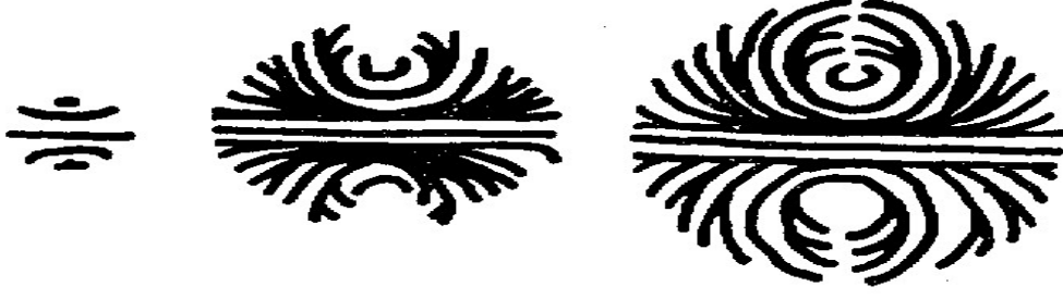
Şekil 2.2. Dallanma frekansı hipotezine göre bir grafit küresinin büyümesindeki muhtemel kademeler [2,18].
