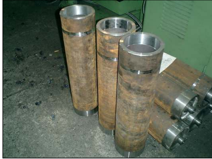
Şekil 4.7 Tanbur gövdelerinin imalat öncesi kılavuzları açılmış (C. Kara, 2008 s.97).
