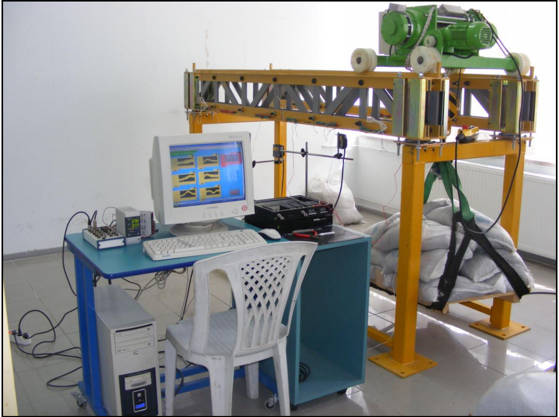
Şekil 5.17 Dinamik gerilme testleri için hazırlanmış deney düzeneği
