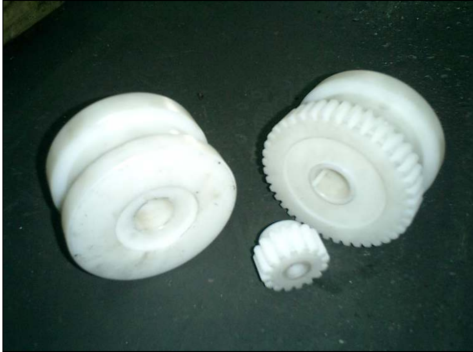
Şekil 4.13 PA6 malzemedan imal edilen pinyon ve araba tekerlekleri(C. Kara, 2008 s.103).
