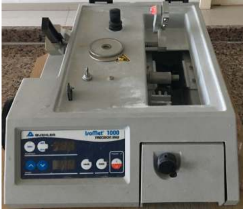
Resim 6: Hassas kesim cihazı ve elde edilen örnek kalınlıklarının ölçülmesi
