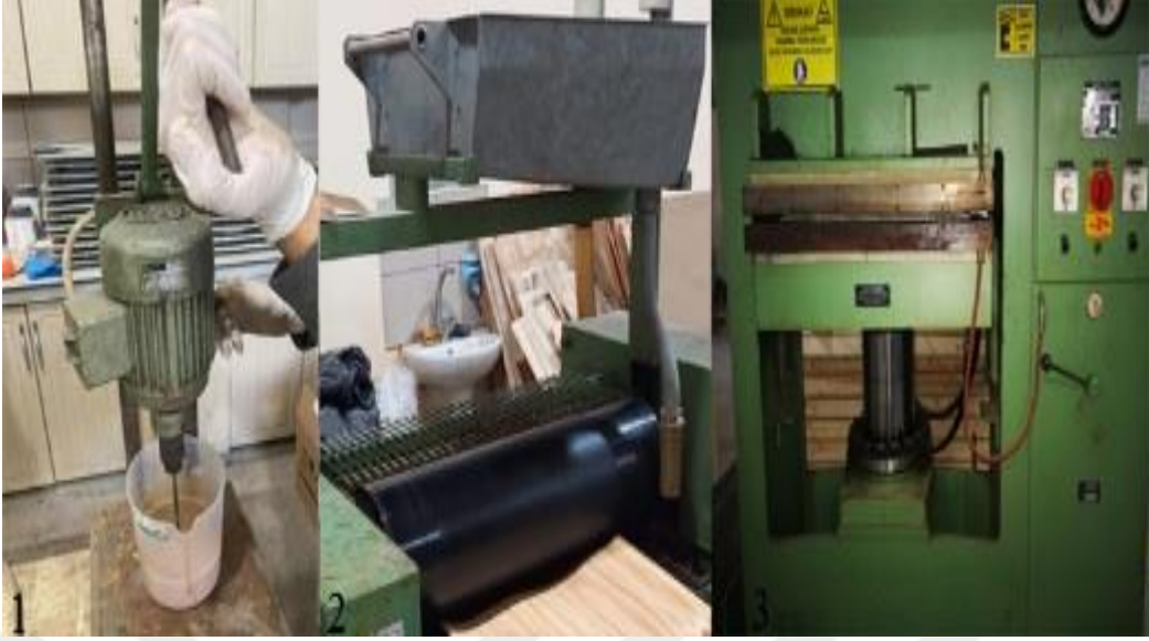
*1: Tutkal karıştırma mikseri, 2: Tutkallama silindiri, 3: Hidrolik pres
