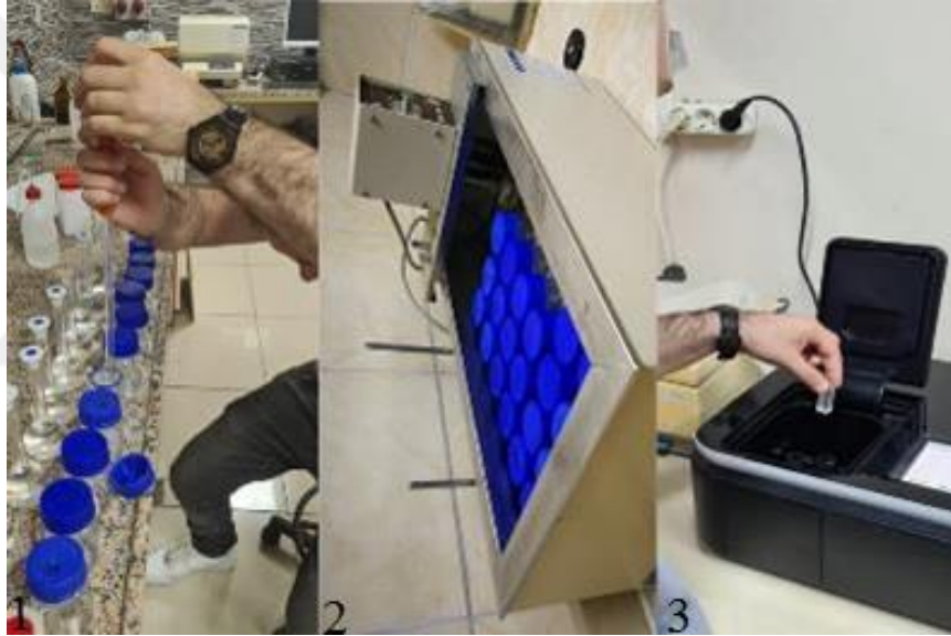
*1: Çözelti hazırlama, 2: Su banyosu, 3: UV-VIS spektrofotometre
