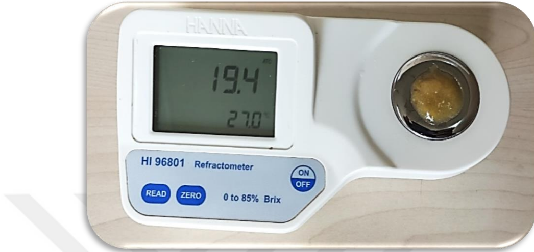
Şekil 3.12. Hanna HI 96801 marka dijital refraktometreye ait bir görünüm
