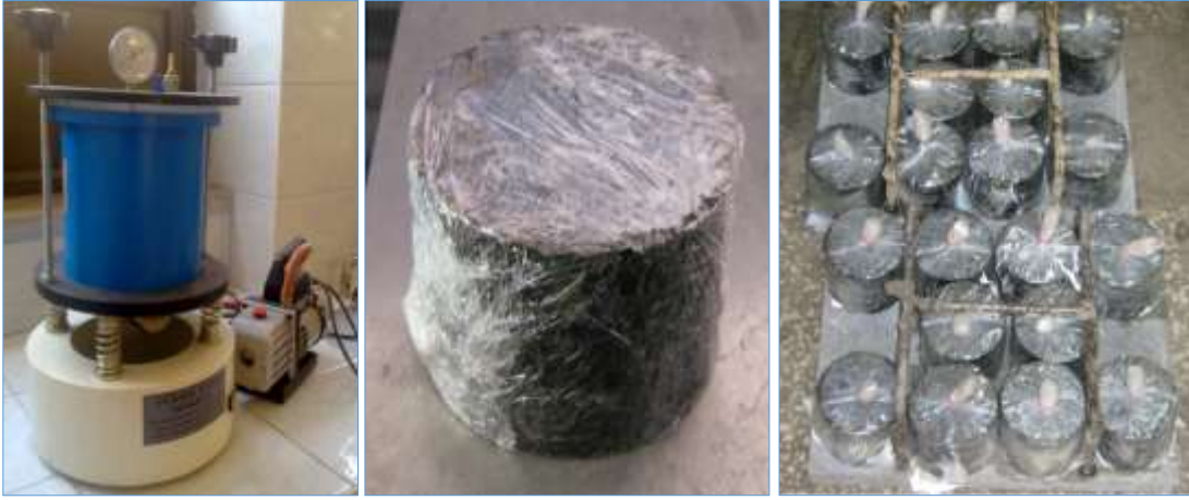
Şekil 5.30. Piknometre ve vakum cihazı, numunelerin koşullandırma işlemi için hazırlanması
