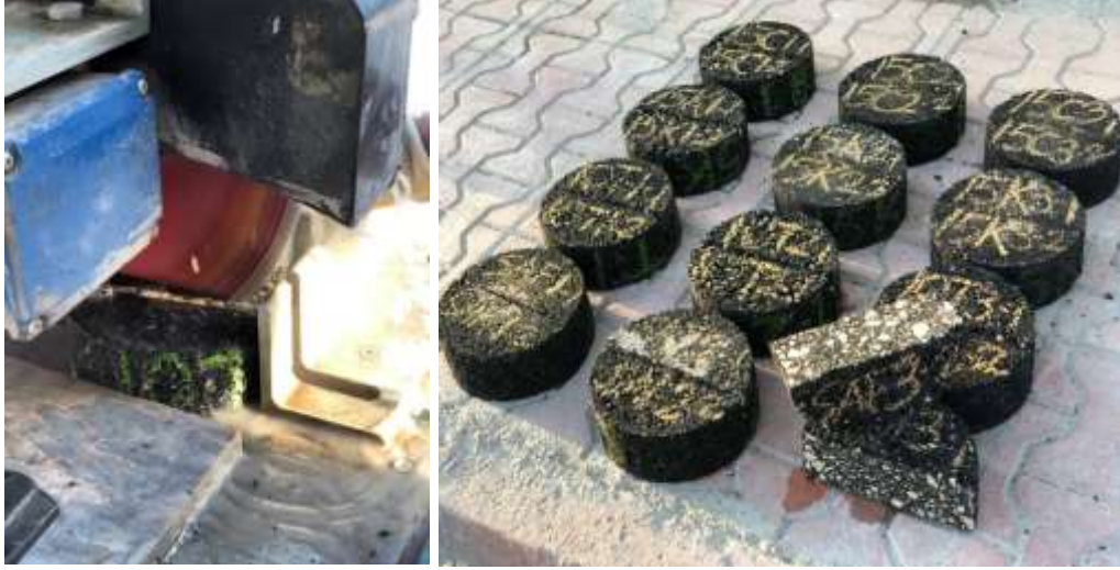
Şekil 6.67. Döner testere ile numunelerin yarım daire şeklinde kesilmesi
