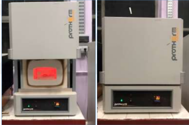
Şekil 6.7. Kül fırını ve krozelerin sabit tartıma getirilmesi
