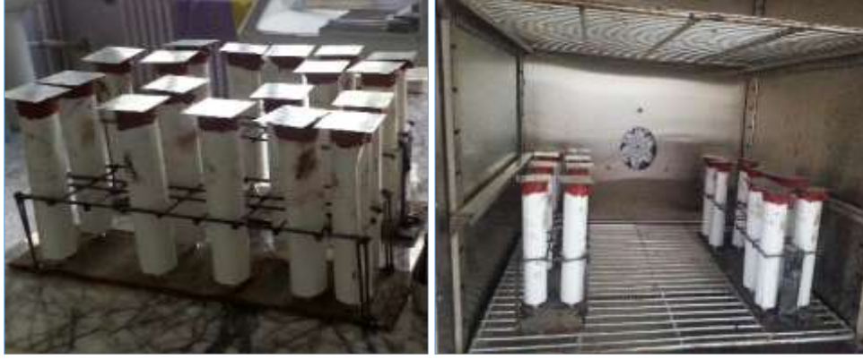
Şekil 5.22. Numune doldurularak ağzı kapatılmış tüplerin dik şekilde etüve yerleştirilmesi
