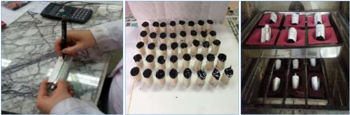
Şekil 5.23. Etüvden çıkarılan tüplerin kesilmesi sonrası alt ve üst parçalarının görünümü
