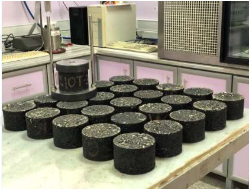
Şekil 6.60. Dinamik sünme deneyi sonrasında numunelerin görünüşü
