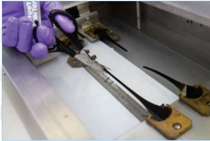
Şekil 5.24. Elastik geri dönme testinde uzayan numunelerin kesilmesi [5]
