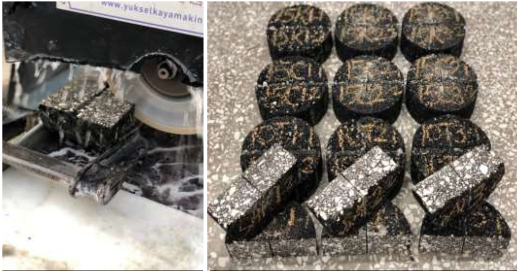
Şekil 6.68. Deney numunelerine çentik açılması ve değişik yükseklikte çentiğe sahip numuneler
