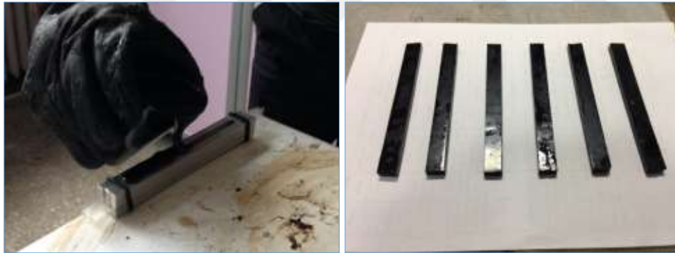
Şekil 5.20. BBR deneyi için numune hazırlanması ve kalıptan çıkartılan numuneler
