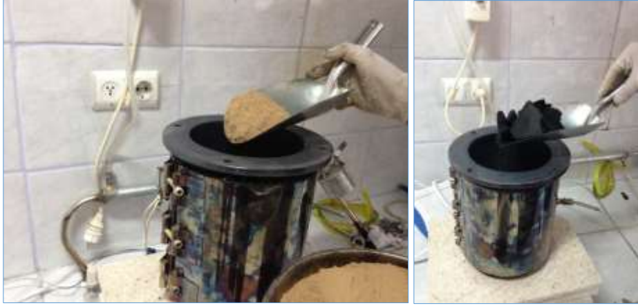
Şekil 5.4. Biyokütlenin piroliz cihazına doldurulması ve deney sonrası elde edilen biyoçarın görünüşü
