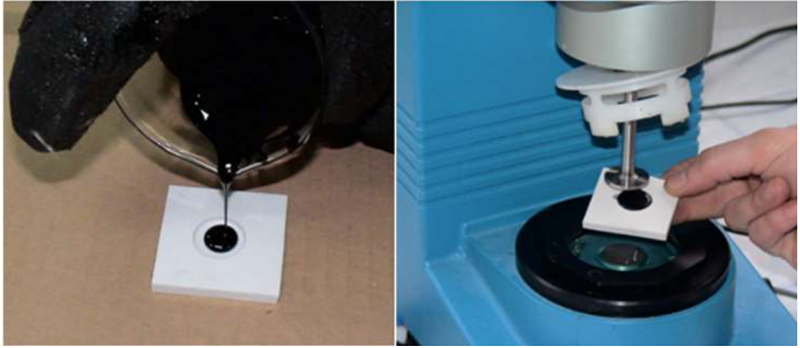
(a) (b) Şekil 5.15. Numunenin silikon kalıba doldurulması (a) ve üst plağa yerleştirilmesi (b)
