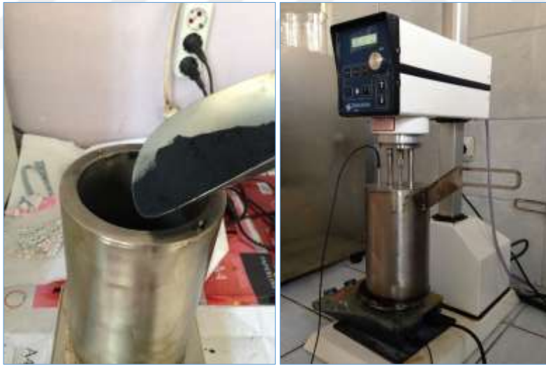
Şekil 6.1. Biyoçarın saf bitüme ilave edilmesi ve yüksek kesmeli (high shear) modifiye bitüm mikseri
