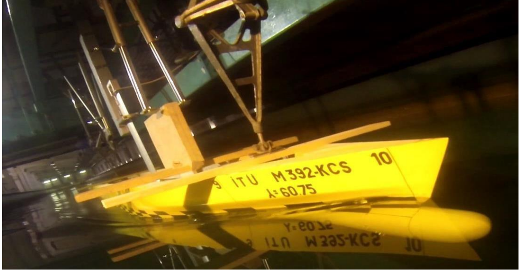
Şekil 1.2 KCS Gemi modeli direncinde belirsizlik analizi testi (Delen, 2015)
