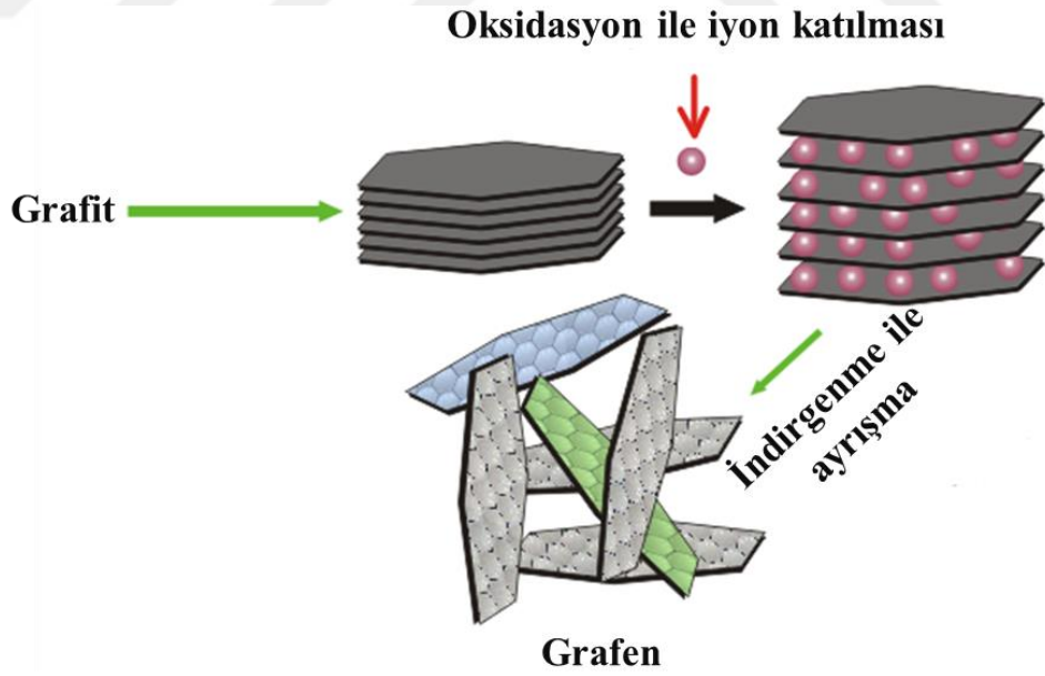
Şekil 1.7. Elektrokimyasal yöntem ile grafen sentezi
