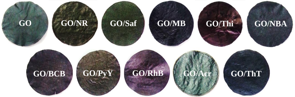
Şekil 3.10. Boyar madde katkılı GO kağıt elektrotların dijital kamera görüntüsü
