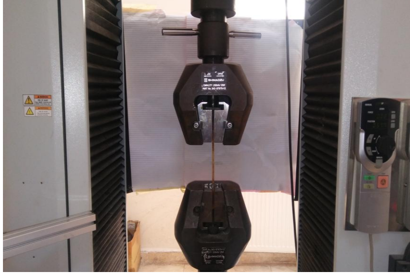
Şekil 3.6. Shimadzu marka çekme test cihazı
