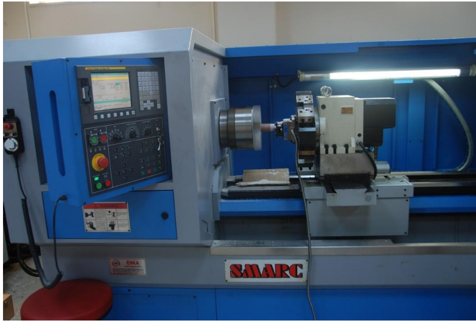
Şekil 3.10. Deneylerde kullanılan CNC torna tezgâhı
