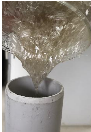
Şekil 3.4. 6 mm elyaf uzunluğu ve %30 elyaf oranına sahip karışımın plastik silindirik kalıba dökülmesi
