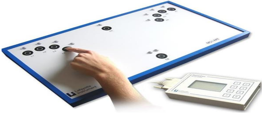
Şekil 3.2. Lafayette Moart Reaksiyon Zamanı Ölçüm Cihazı
