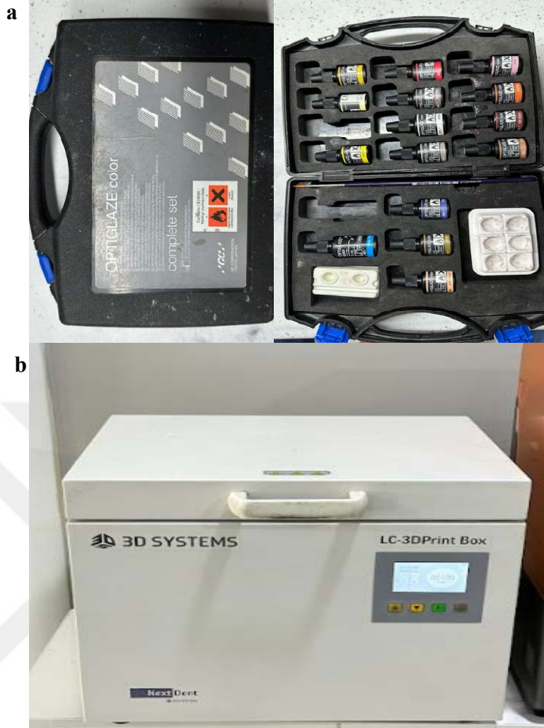
Resim 16. Kullanılan glaze seti ve polimerizasyon ünitesi (a) Optiglaze Color (GC, Tokyo, Japonya) glaze seti. (b) NextDent LC-3D Print Box (Barselona, İspanya) cihazı.
