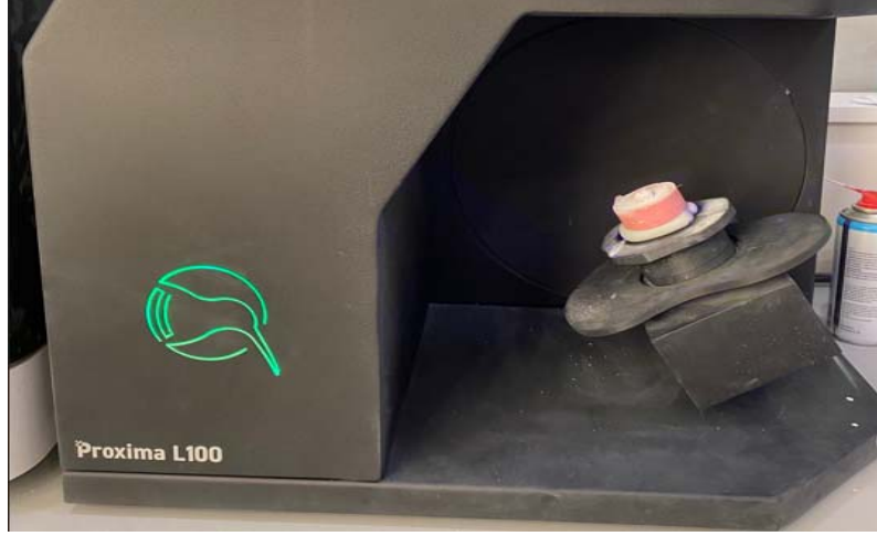
Resim 8. Restore edilecek olan örnek diřin yüzeylerinin pudralandıktan sonra taranması
