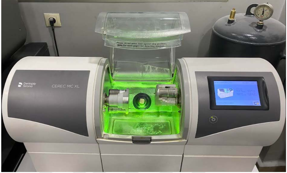
Resim 19. Restorasyonların üretiminde kullanılan CEREC inLab MC XL cihazı (Sirona, Bensheim, Almanya)
