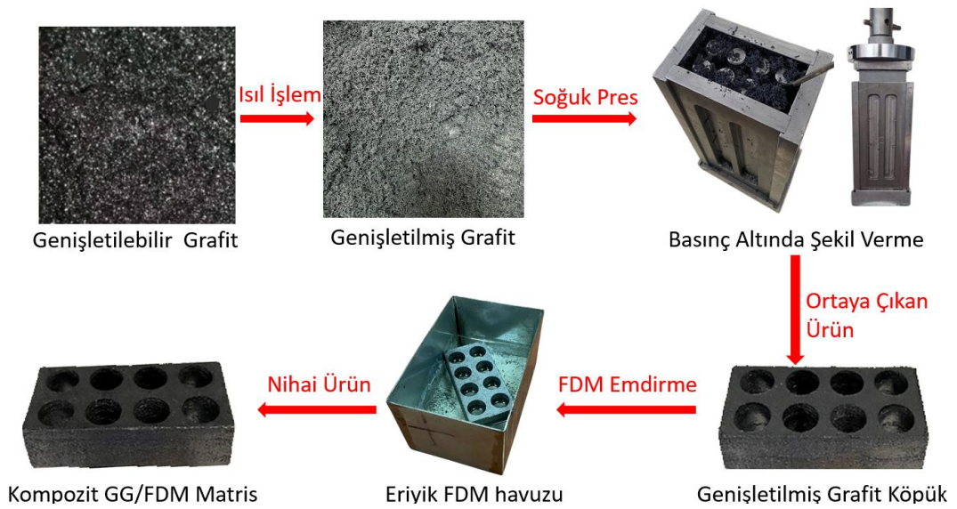
Şekil 11. Genişletilebilir grafitten GG/FDM kompozit matris üretim süreci
