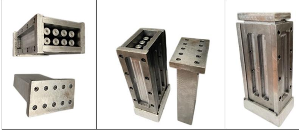
řekil 12. Presleme ile grafit kpk matris oluřturmak iin retilen kalıp
