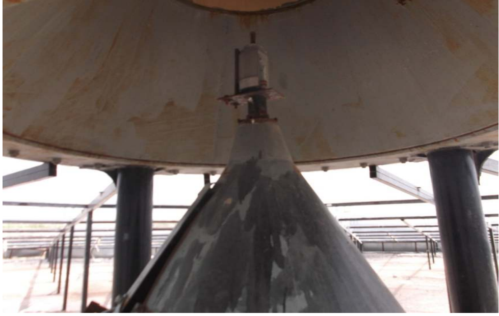
Şekil 3.27 Güneş bacası sisteminde kullanılan jeneratörün iç huni üzerine montajı
