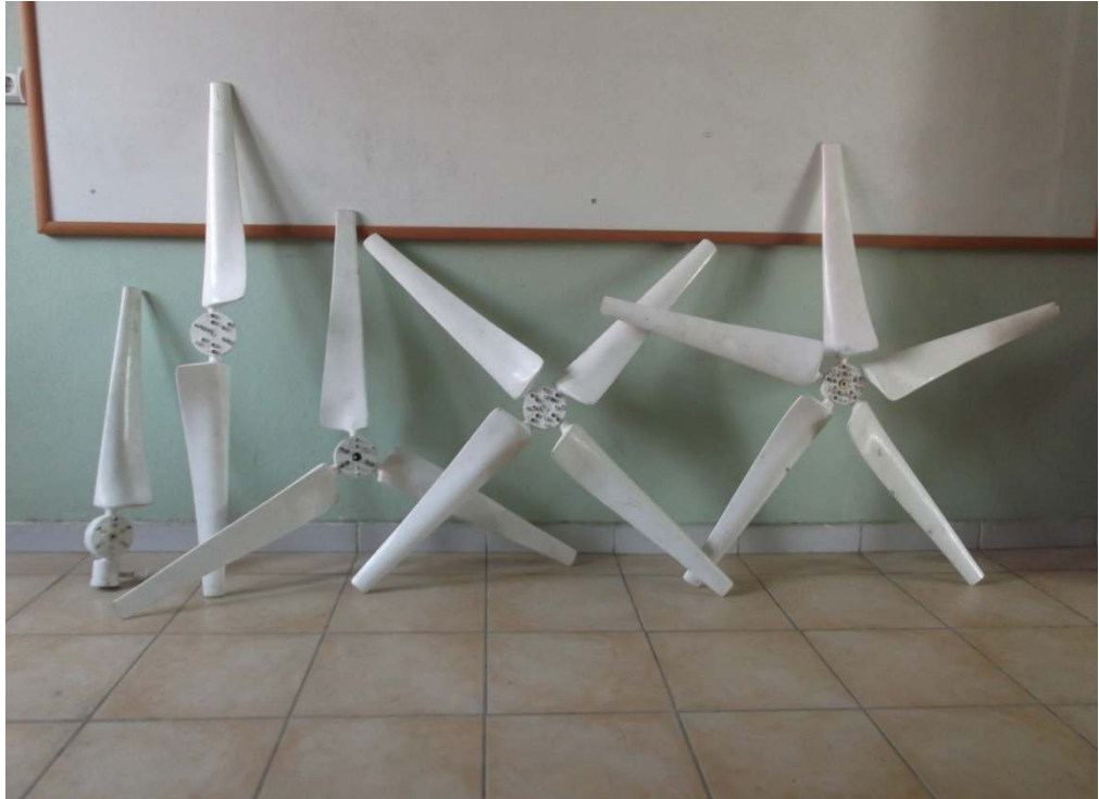
Şekil 3.25 Güneş bacası sisteminde kullanılan türbinler ( r = 0.6 m)
