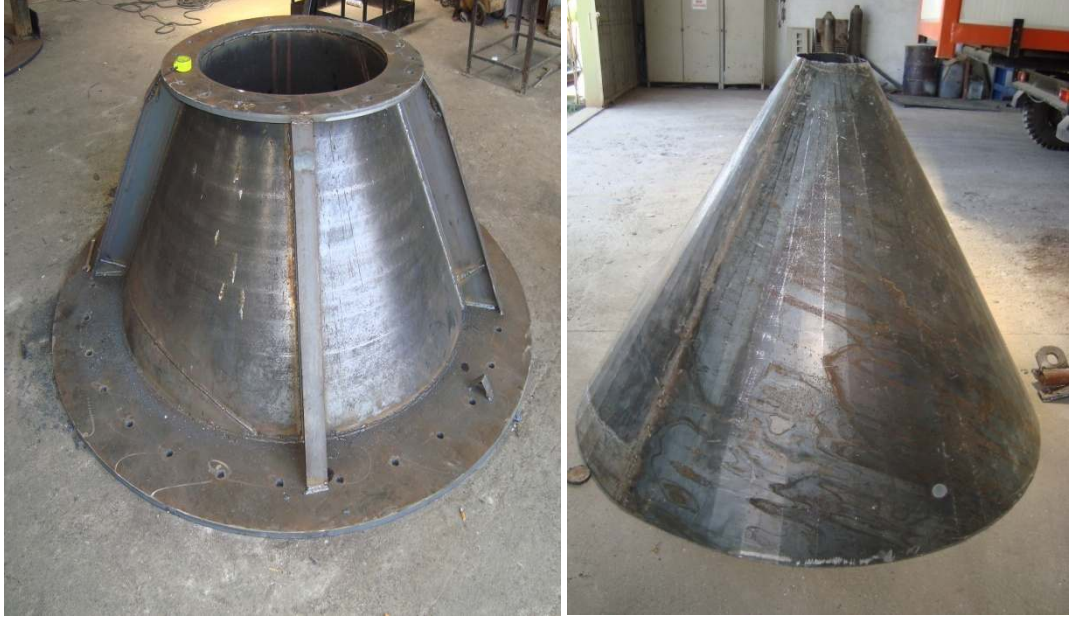
Şekil 3.16 Güneş bacası sistemi için hazırlanan ana huni ve i huni
