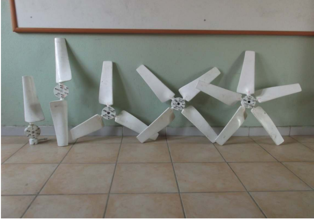
Şekil 3.24 Güneş bacası sisteminde kullanılan türbinler ( r = 0.4 m)
