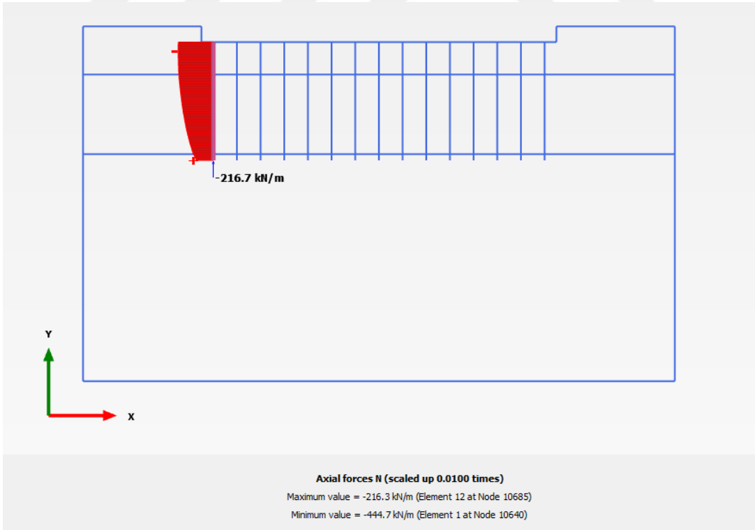
Şekil 40. 80 cm'lik kazık için eksenel kuvvet
