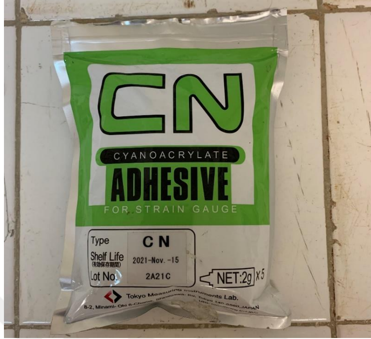
Şekil 26: Gerinim Pullarını Boruya Sabitlemek İçin Kullanılan Yapıştırıcı
