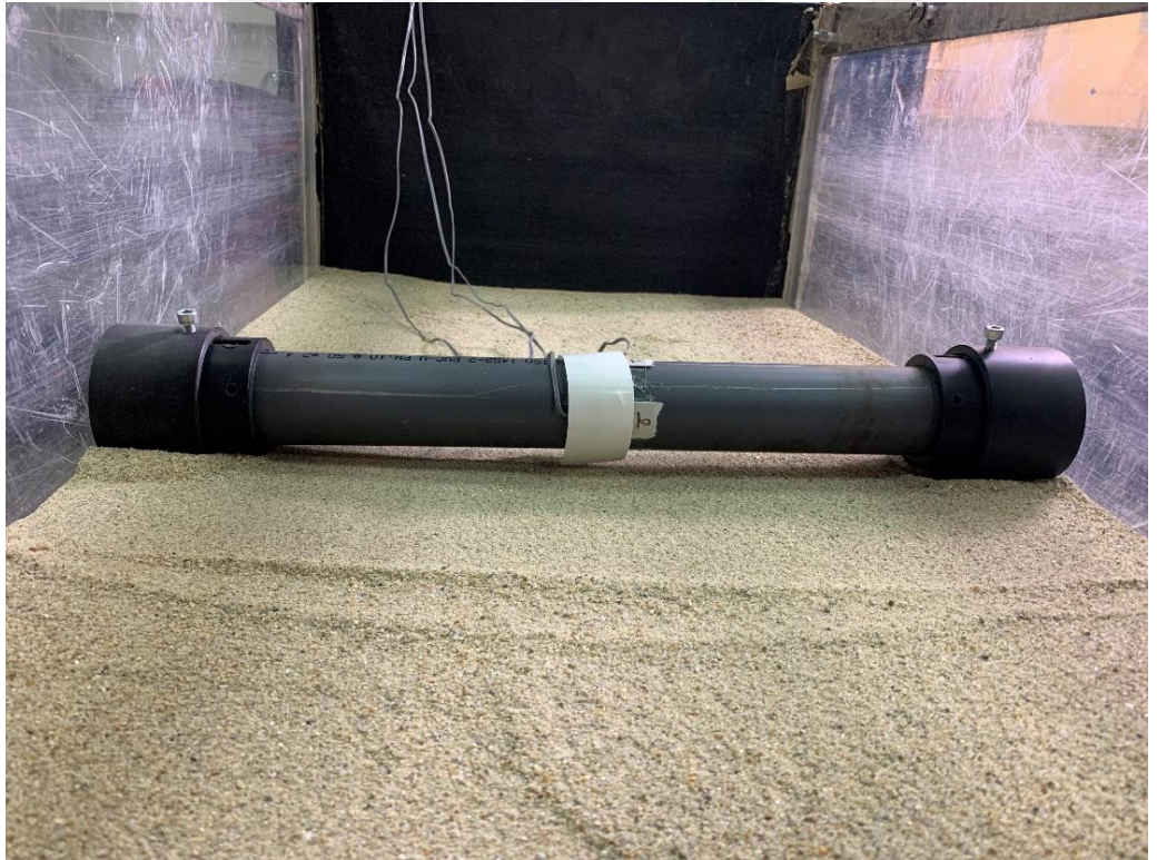
Şekil 37: Borunun Zemine Yerleştirilmesi
