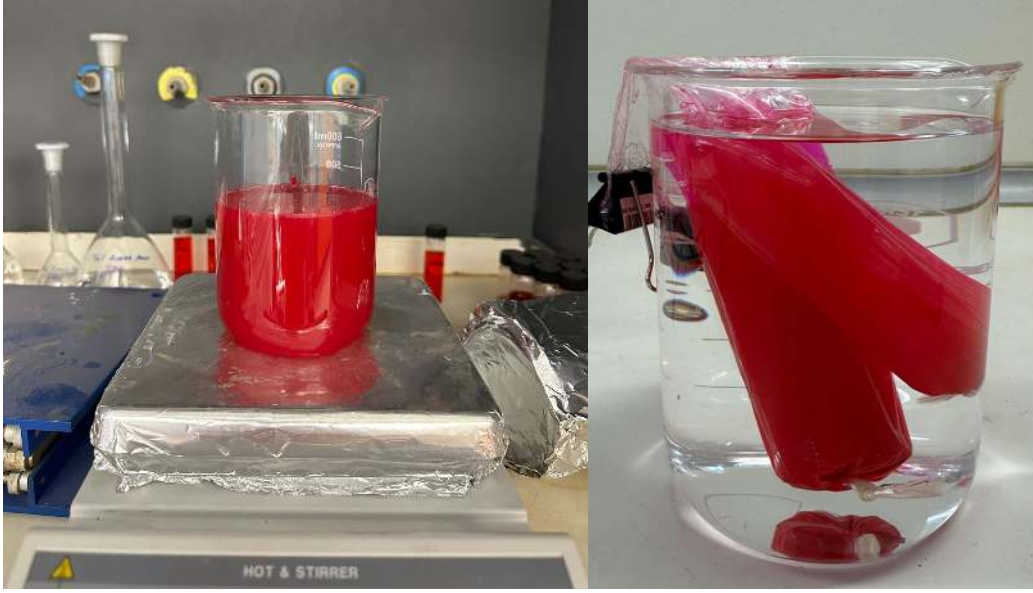
Resim 3.11 A) Rose bengalin manyetik karıştırıcı altında eklenmesi B) Diyaliz membranına konulan solüsyon
