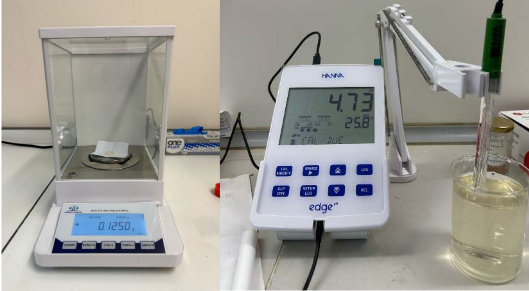
Resim 3.4. Kitosanin hassas terazide tartılması ve pH'ının ölçümü
