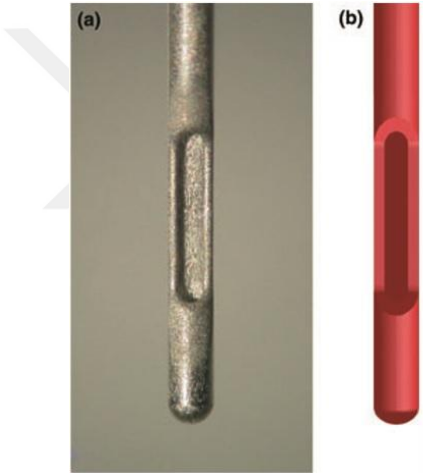
Resim 5. 30G yandan açıklığı olan iğnenin uç kısmının a) dijital görüntüsü, b) katı model görüntüsü (18).
