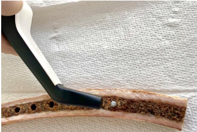
Şekil 10. Ostell Beacon (Göteborg, İsveç) cihazı ile RFA ölçümü yapılması
