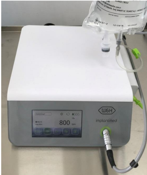
Şekil 8. İmplantları yerleştirmek ve mekanik ölçümleri yapmak için kullanılan fizyo dispenser (W&H İmplantmed Bürmoos, Avusturya)
