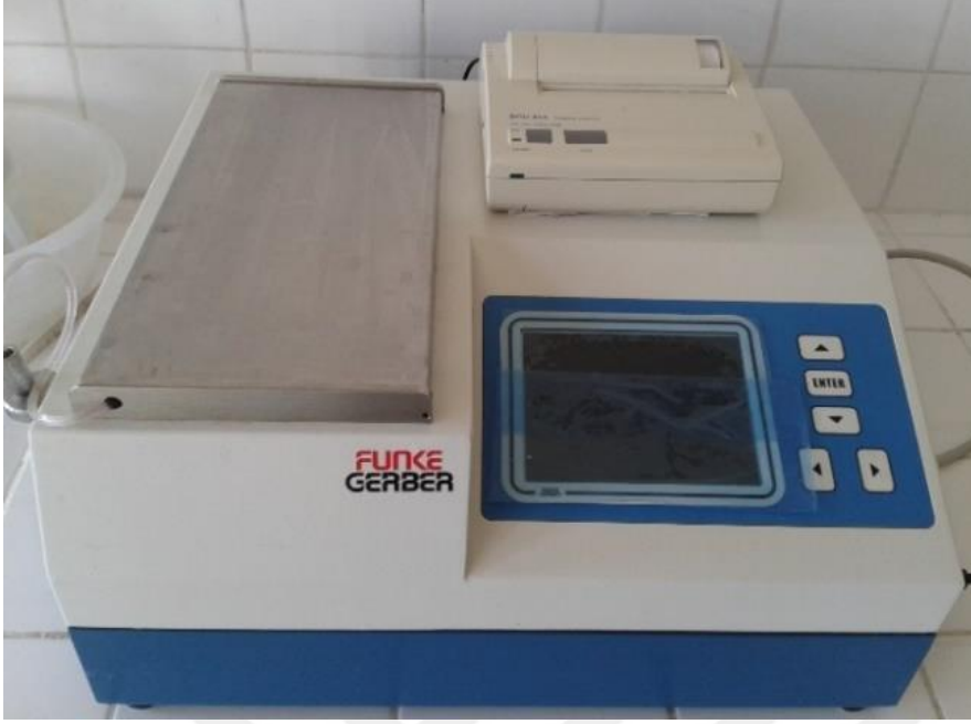
Şekil 3.1. Funke Gerber LactoStar (3510) Süt Analiz Cihazı
