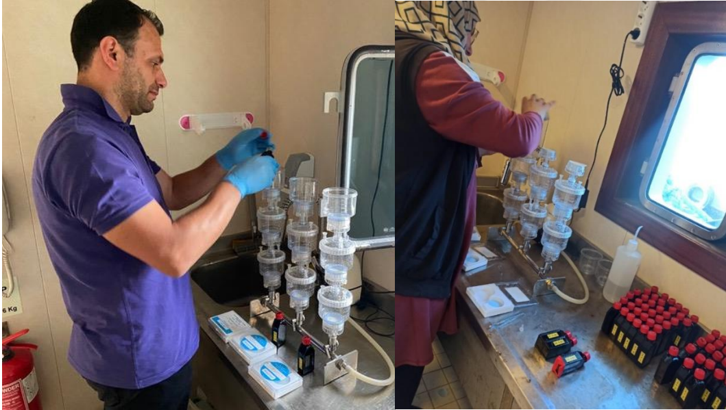
Şekil 17. İnkübasyon sonrası örneklerin farklı göz açıklığındaki filtrelerden süzülmesi aşaması
