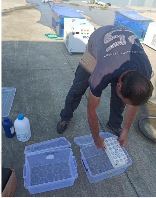
Şekil 18. Analiz öncesi örneklerin derişik formaldehit ve konsantre HCL buharına tabi tutulması aşaması
