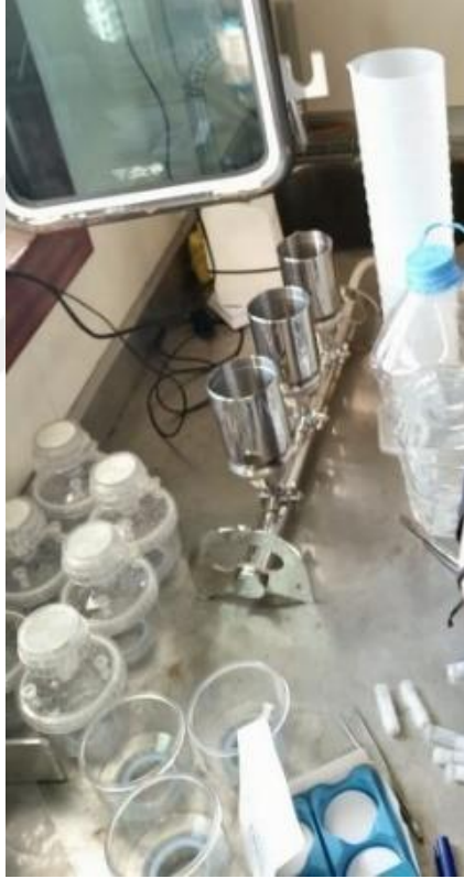
řekil 12. 47 mm aplı GF/F filtrelerden s z lme iřlemi
