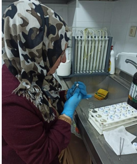
Şekil 19. Analiz öncesinde viallere sintilasyon kokteyli ekleme aşaması
