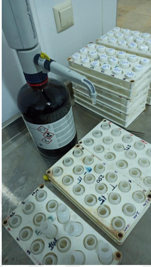
Şekil 20. Analiz öncesinde viallere sintilasyon kokteyli ekleme aşaması
