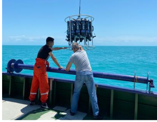
Şekil 5. Çoklu su örnekleyici (SBE 32 Carousel)
