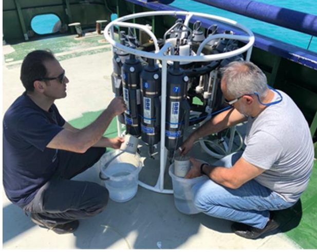
Şekil 10. Deneyler öncesi deniz suyu örneklerinin 200 \mu\text{m} 'lik plankton ağından süzülmesi aşaması
