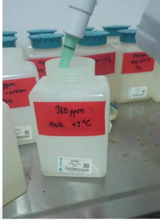
Şekil 15. Son konsantrasyon hacmi 7.5 ml kalan örneklerin 10ml lik viallere alınması
