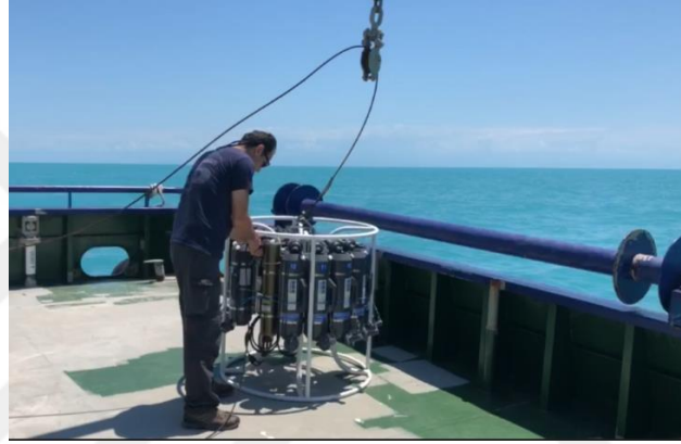
Şekil 6. Çoklu su örnekleyici (SBE 32 Carousel)
