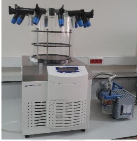
Şekil 3.1.: Örneklerin dondurularak kurutulduğu dondurarak kurutucu
