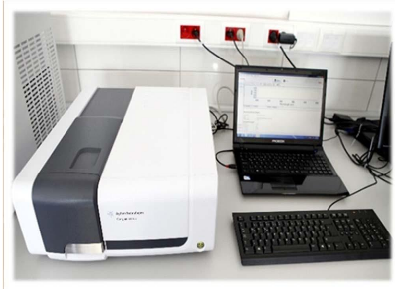
Şekil 3.4: Analizde kullanılan spektrofotometra cihazı
