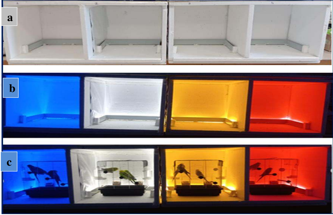
Şekil 2.6. Çalışmada kullanılmak için hazırlanan bölmeler. (a: Boş bölmeler, b: Aydınlatılmış bölmeler, c: Çalışma bölmeleri)
