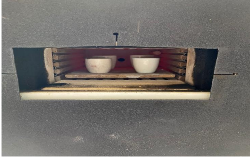
Resim 3.4 Fırında krozelerin içinde yakma işlemi.
