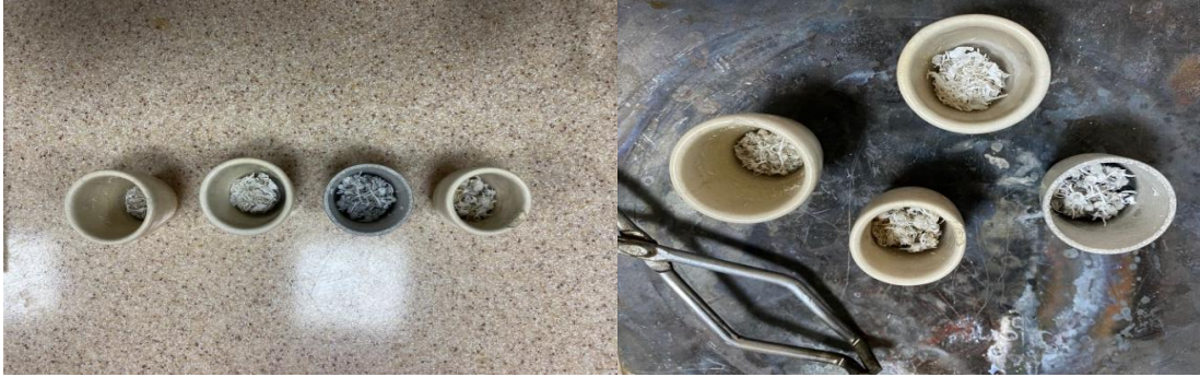
Resim 3.5 Kroze içinde yanmış ekinezya ( E. purpurea ) ve tıbbi papatya ( M. chamomilla ) örneklerinin krozelerde yakılmış hali.
