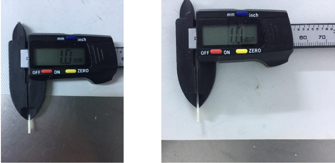
Şekil 3-8: C & D Bağlanma yüzey alanı hesaplaması için örneklerin boyutlarının ölçülmesi
