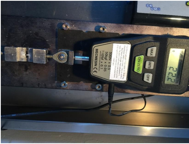
Şekil 3-8: A Dentin çubuklarına mikro-gerilim test cihazında kuvvet uygulanması
