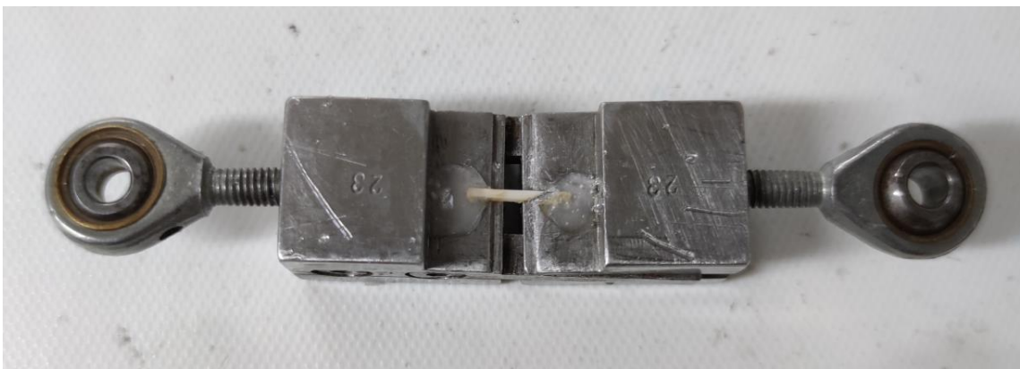
Şekil 3-8: B Test esnasında ayrılan ve çalışma dışı bırakılan bir dentin çubuğu
