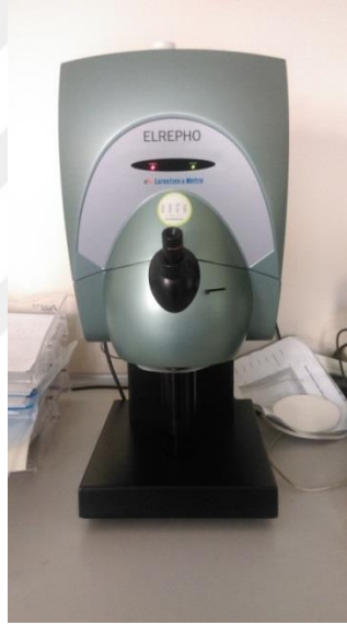
Fotoğraf 3.10. Renk değişimini belirleme cihazı
