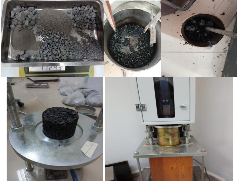
Şekil 3.12. Karışımın hazırlanma ve sıkıştırılma aşamaları
