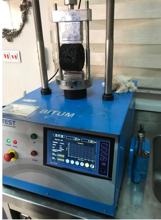
Şekil 3.14. İndirekt çekme mukavemeti deneyi cihazı
