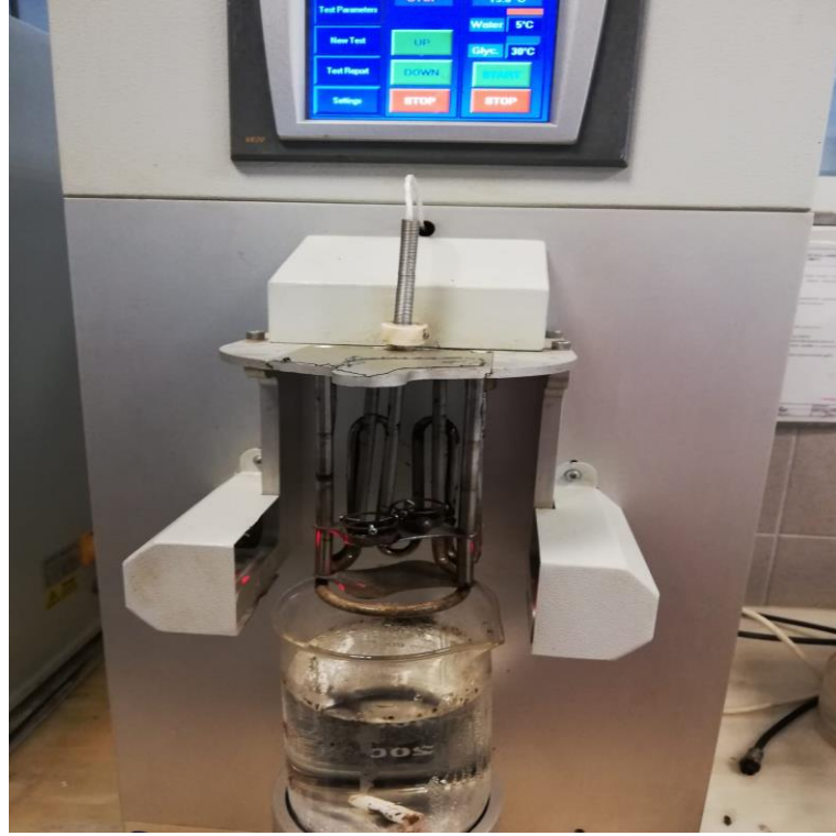
Şekil 3.3. Yumuşama noktası deneyi
