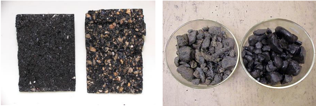
Şekil 2.10. Nem hasarı sebebiyle agrega-bitüm kopması ve soyulma performansı
