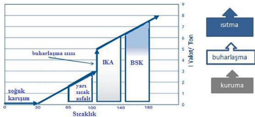
Şekil 2.1. Üretim sıcaklıklarına göre karışımların sınıflandırılması
