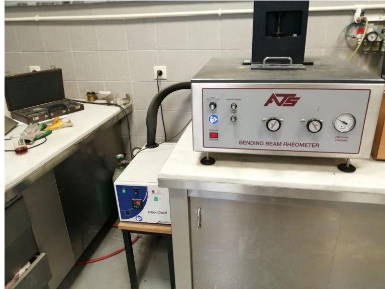
Şekil 3.9. Eğilme kirişi reometresi
