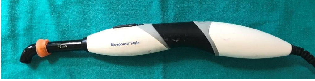
Resim 8. Akışkan kompozit örneklerin polimerizasyonunda kullanılan Bluephase Style LED ışık cihazı
