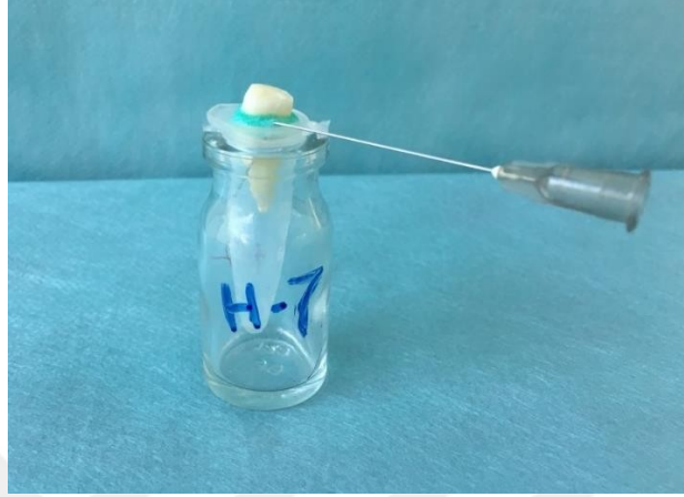
Şekil 3.3. Taşan debrisin toplanması için kurulan deney düzeneği
