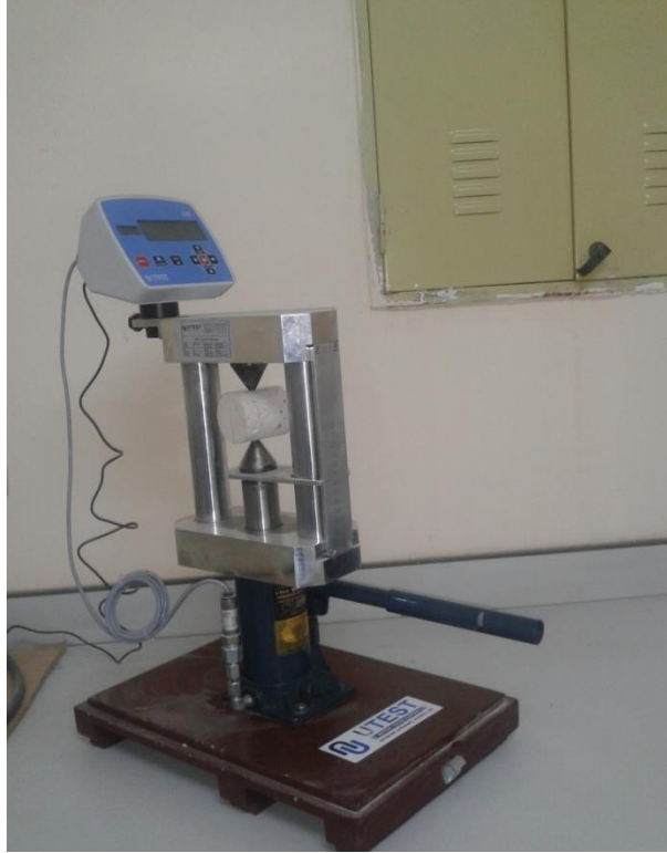
Şekil 4.7. Nokta yükleme test cihazı
