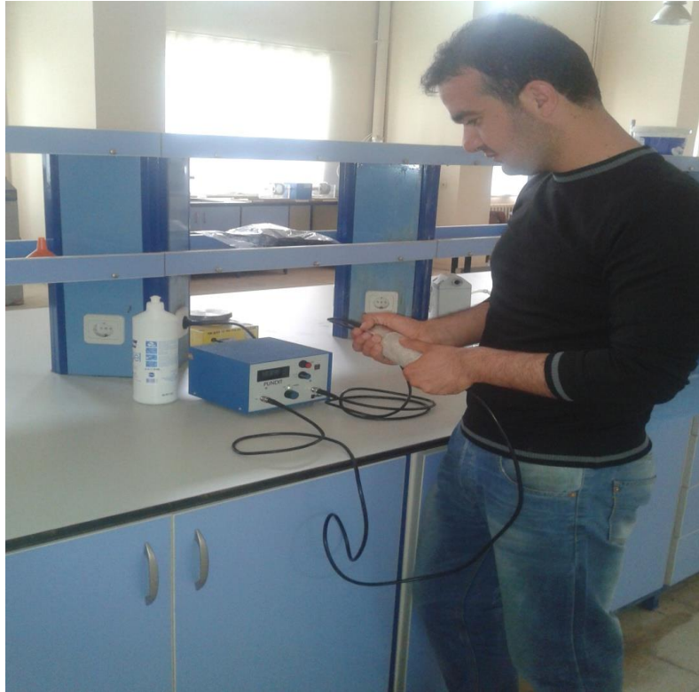
Şekil 4.9. Sonik hız deneyi cihazı
