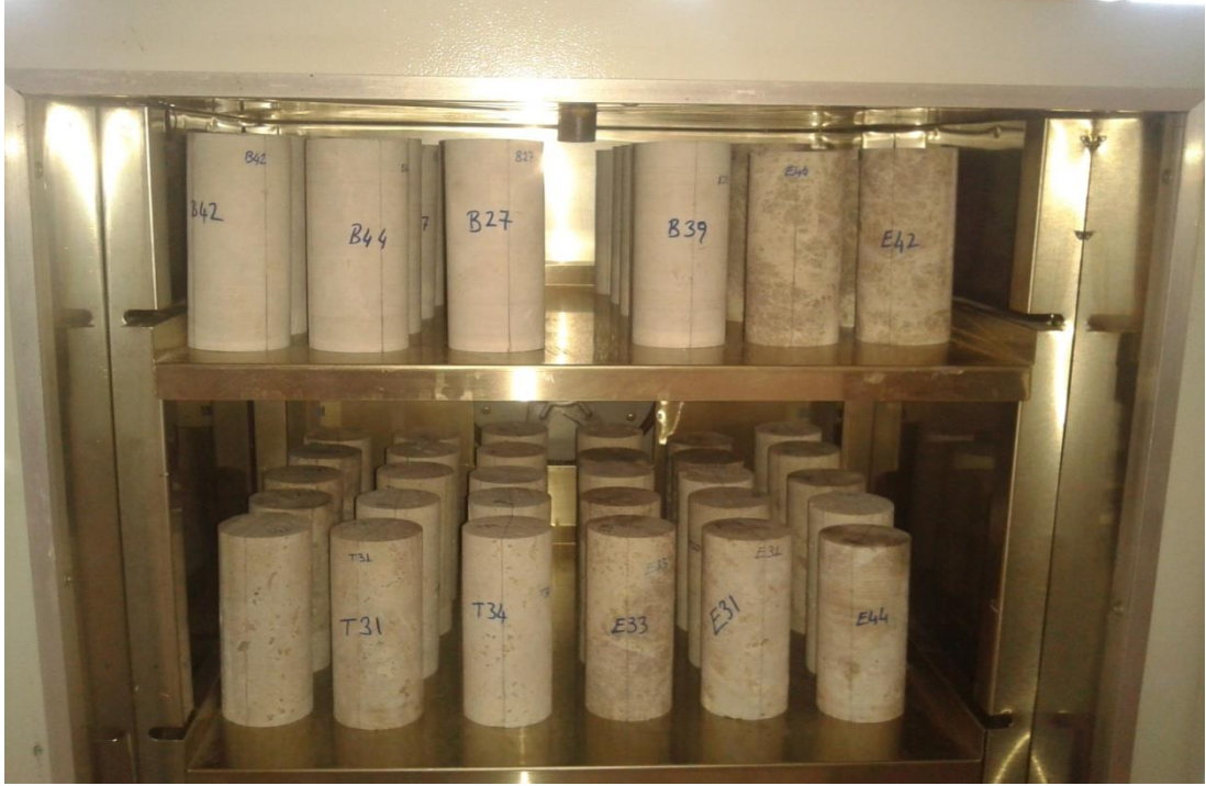
řekil 4.2. Kayaların fiziksel zelliklerini belirlemede kullanılan numuneler
