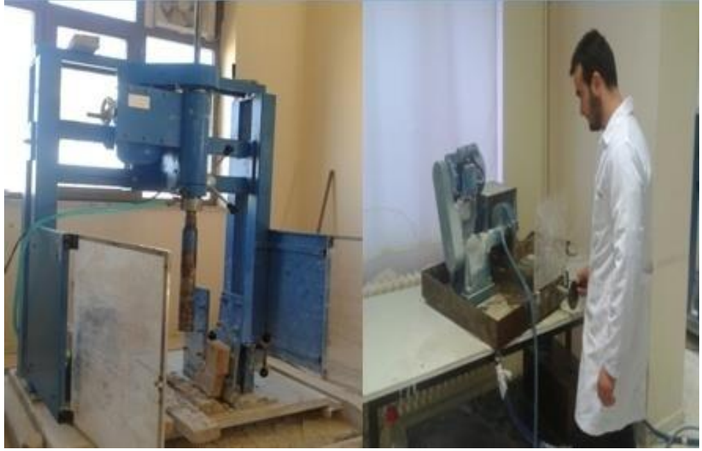
Şekil 4.1. Karot alma makinesi ve Karot ucu kesme ve düzeltme makinesi
