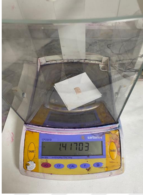
Fotoğraf 3.6: T-PRF membranların ağırlık ölçümü için kullanılan cihaz.
