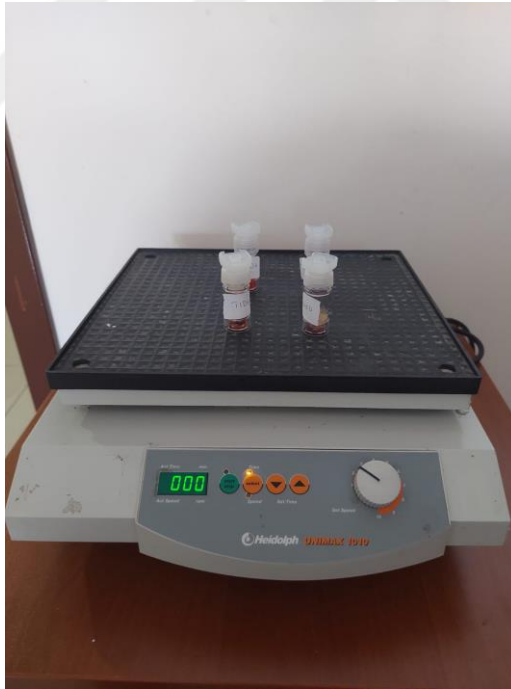
Fotoğraf 3.7: T-PRF membranların orbital çalkalama cihazındaki yerleşimi
