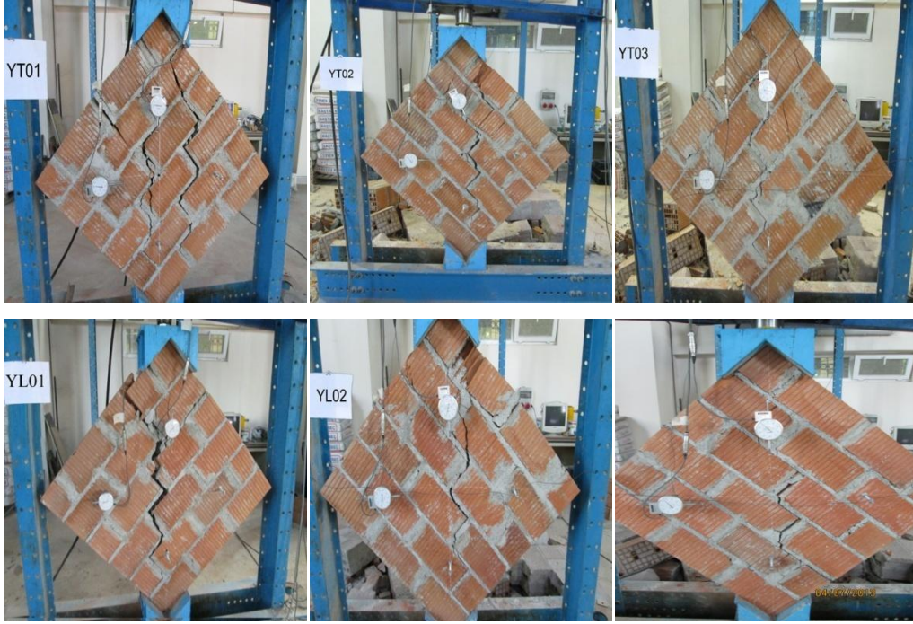
Resim 4.2. Yığma tuğla ile örülen duvar numunelerinin göçme biçimleri
