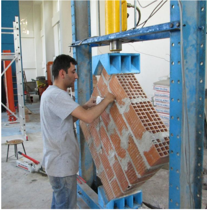
Resim 3.1. Şekil değiştirme ölçerlerin montajı ve deney düzeneği
