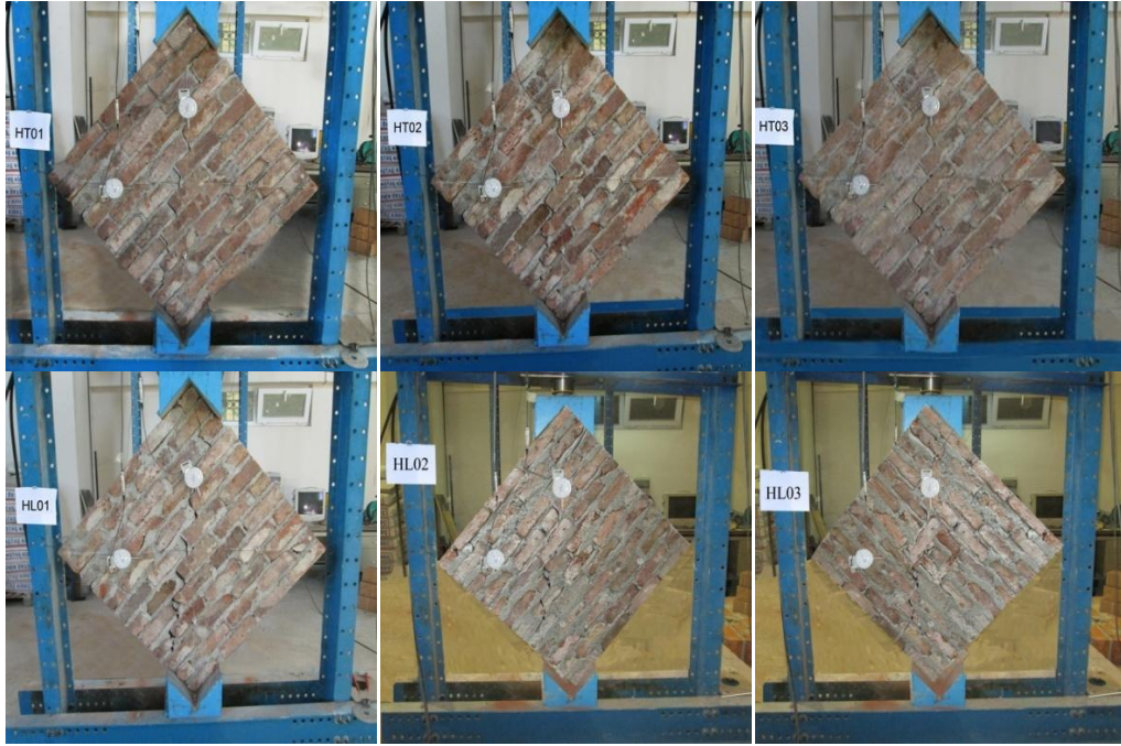
Resim 4.1. Harman tuğlası ile örülen duvar numunelerinin göçme biçimleri
