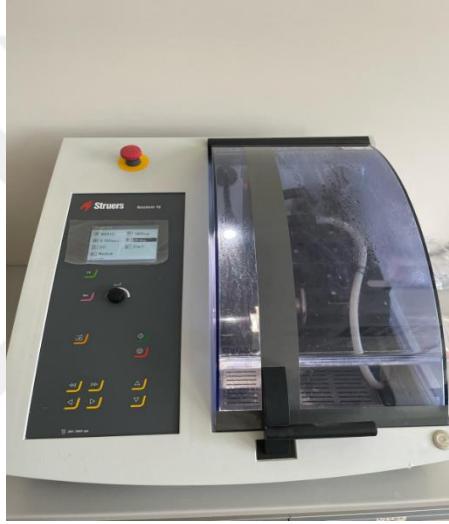
Şekil 3.5. Dişlerden yatay kesit almak için kullandığımız hassas kesim cihazı
