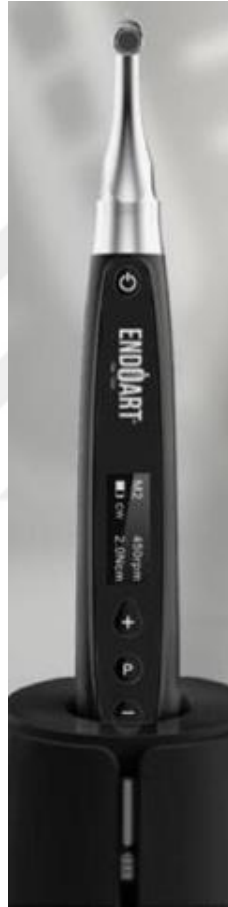
Şekil 3.4. Çalışmamızda kök kanal şekillendirmesi yapmak için kullandığımız endomotor
