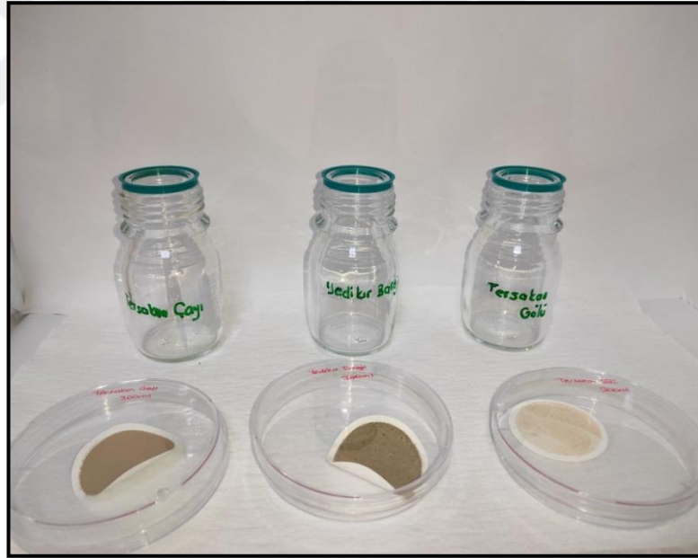
Şekil: Tersakan Çayı, Yedikır Barajı ve Tersakan Gölü filtre (47 mm, 0,22 µm Merck Millipore filtre) örnekleri
