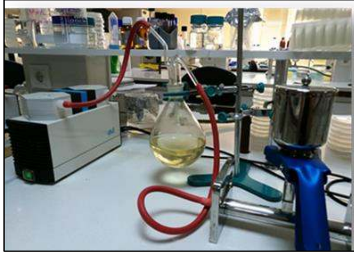
Şekil 2.9. Su örneklerinin filtrasyon düzeneği
