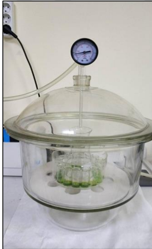
Şekil 2.12. Ekstrelerin vakum altında kurutulma işlemi
