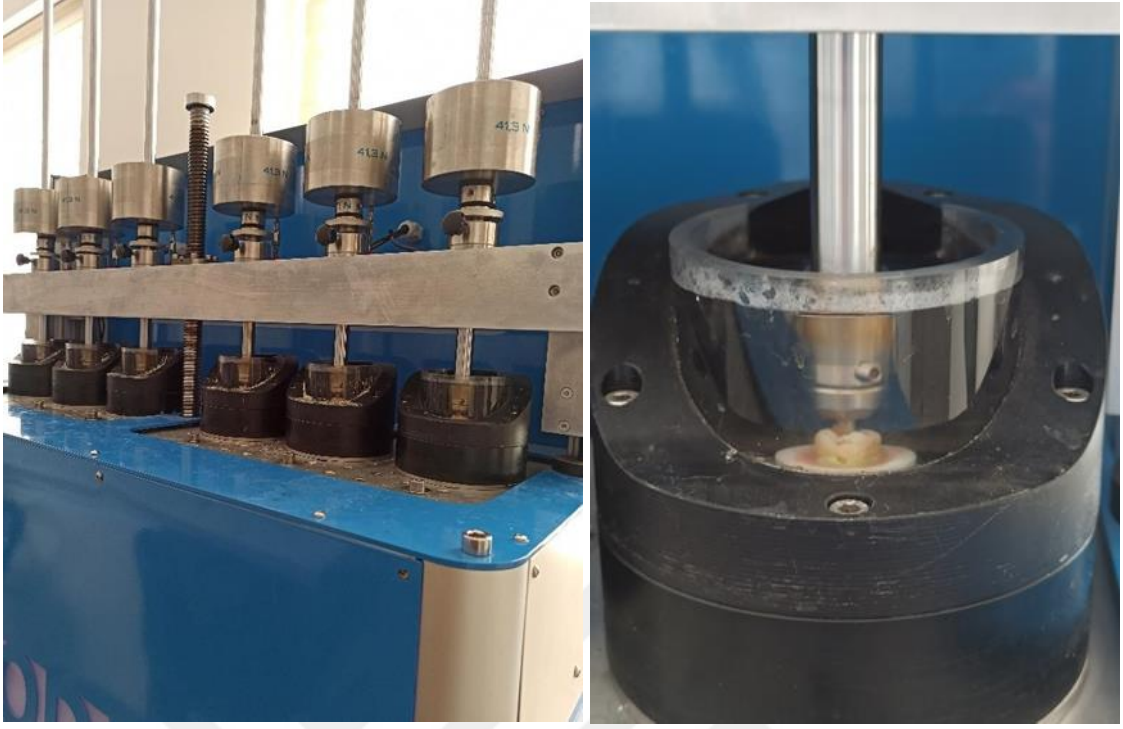
Resim 17. Örneklerin 6 sarlı gruplar halinde çiğneme simülatörünayerleştirilmesi
