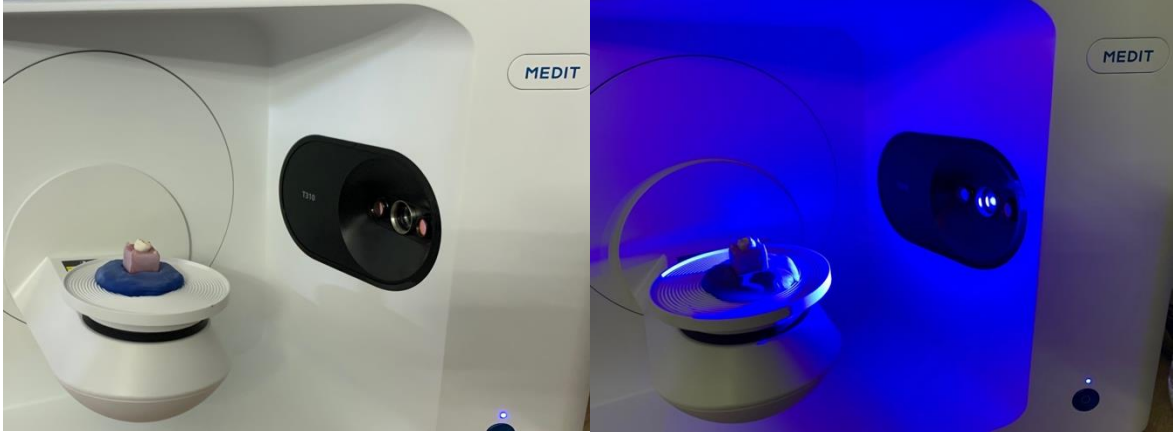
Şekil 3.9. Preparasyon modelinin Medit T310 laboratuvar tarayıcısı ile taranması
