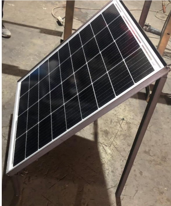
Şekil 3. 3. 110W Monokristal panel konstrüksiyonu
