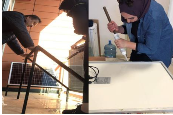
Şekil 3. 4. Cam çerçevenin silikonlanması ve sızdırmazlık testi aşamaları
