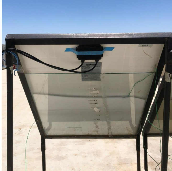
Şekil 4. 8. P4'ün C_{18}H_{36}O_2 eklendikten sonra arka yüzeyi
