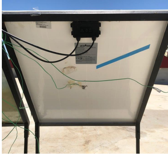
Şekil 4. 2. P1 Boş panel'in arka yüzeyi
