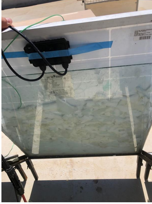
Şekil 4. 4. P2 Parafin eklendikten sonra panelin arka yüzeyi
