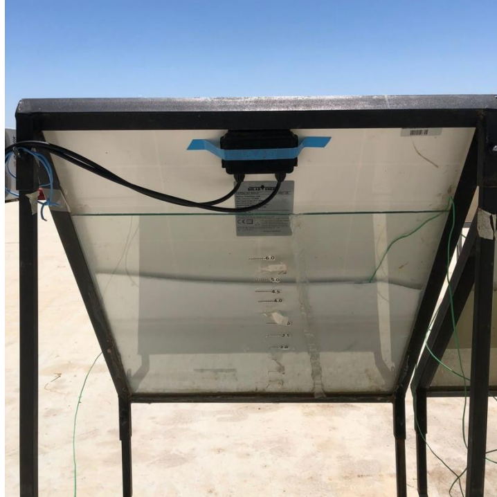
Şekil 4. 8. P4'ün C_{18}H_{36}O_2 eklendikten sonra arka yüzeyi
