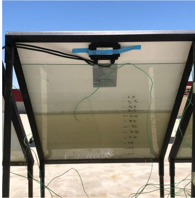
Şekil 4. 6. P3 \text{CaCl}_2 \cdot 6\text{H}_2\text{O} eklendikten sonraki arka yüzeyi
