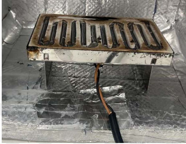
Şekil 30. Harici Isı Kaynağı Konumlandırılması
