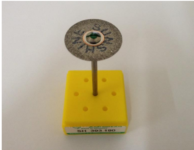
Şekil 3.7 Kesit alma işlemleri için kullanılan elmas disk
