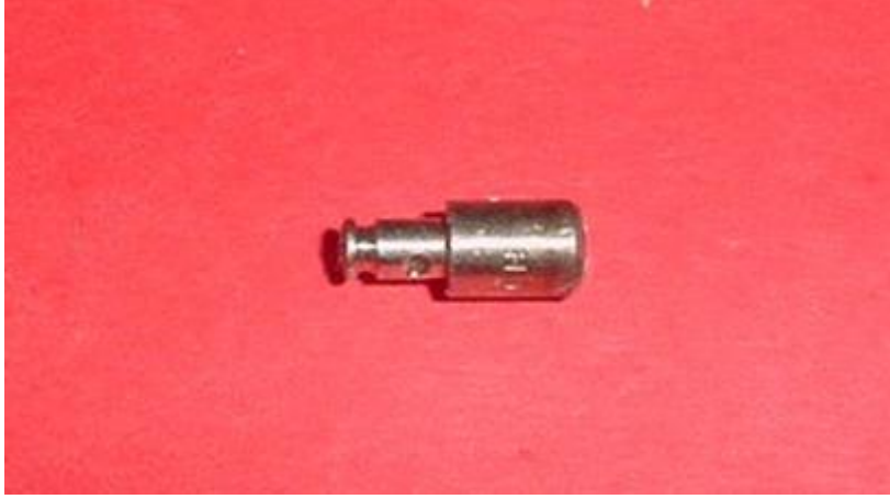
Şekil 4.10 : Denejde kullanılan Co-60 gama radyoizotop kaynağı.
