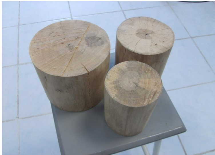
Şekil 4.6: Boyun simülasyonu için kullanılan masif fantomlar.
