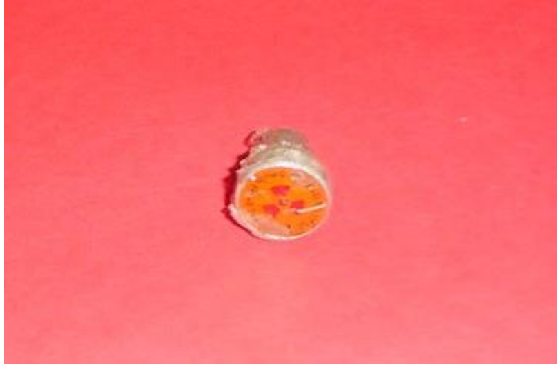
Şekil 4.11 : Denejde kullanılan Cs-137 gama radyoizotop kaynağı.
